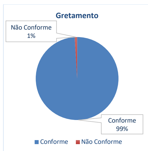
Figura 30: Resultados dos ensaios de determinação da resistência ao gretamento dos produtos esmaltados avaliados.
