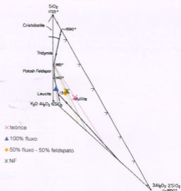
Figura 13 - Localização, no triângulo de compatibilidade 3Al_2O_3.2SiO_2 - K_2O.Al_2O_3.6SiO_2 , das composições em estudo, mostrando as alavancas que permitem calcular a quantidade de fase líquida no início da fusão.
