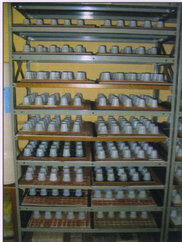
Figura 02: Ensaio de ataque químico de produtos esmaltados.
